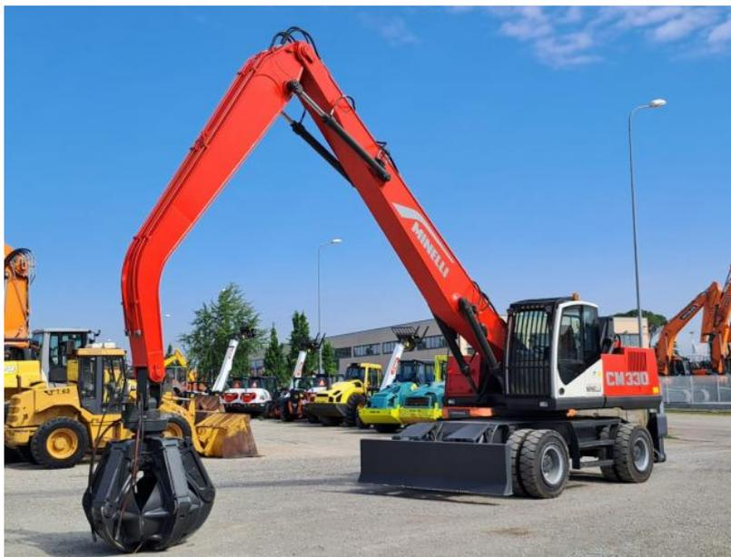
Note: CARICATORE MINELLI CM330.12 CON GRIGLIA , LAMA E STABILIZZATORI , COMPRESIVO DI RELATIVO POLIPO A 5 CHELE della CAT ,SBRACCIO 11.6 MT , LARGHEZZA 2.80 MT, MOTORE IVECO , IMPIANTO DI INGRASSAGGIO AUTOMATICO, PESO MEZZO 320 quintali , CON ARIA CONDIZIONATA, MEZZO APPENA RIPRISTINATO ESTETICAMENTE , MECCANICA E IDRAULICA OK , MEZZO FUNZIONANTE
